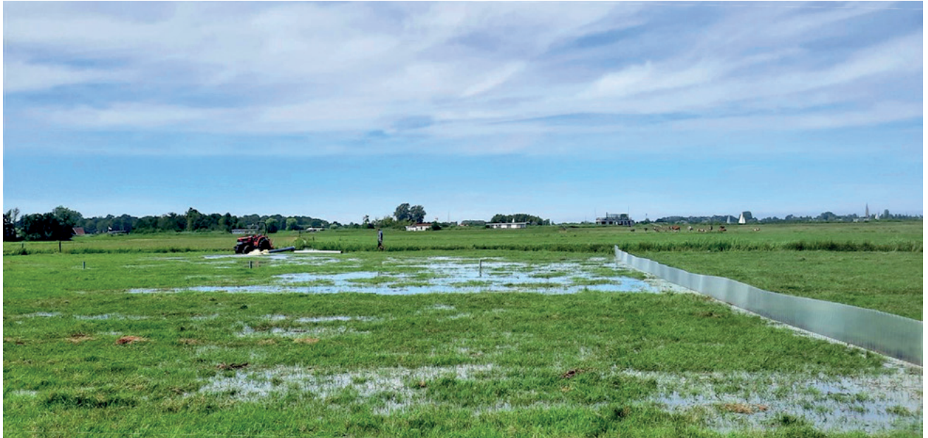
Figuur 6: Inundatieproef in volle gang
