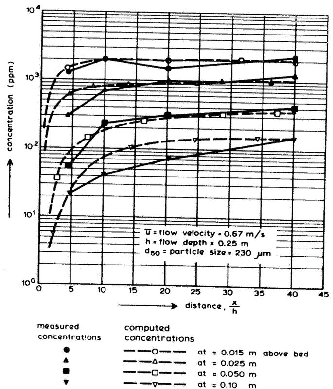
FIG.5 LONGITUDINAL DISTRIBUTION OF SEDIMENT CONCENTRATIONS
