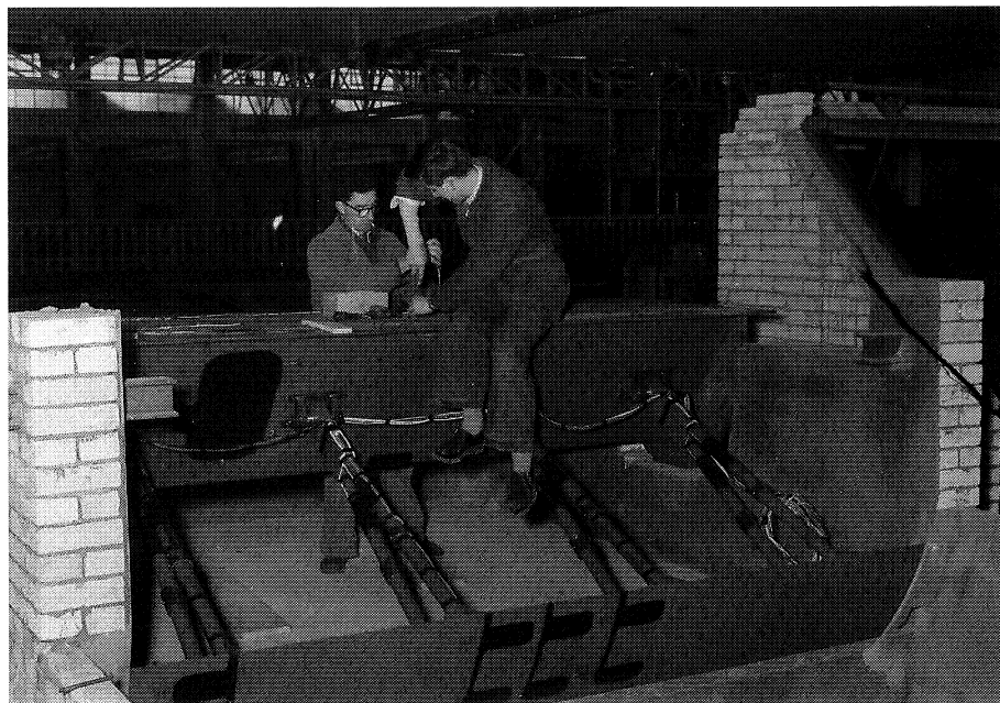
Figuur A: Het elastisch gelijkvormige model van schuiven en brugligger.
