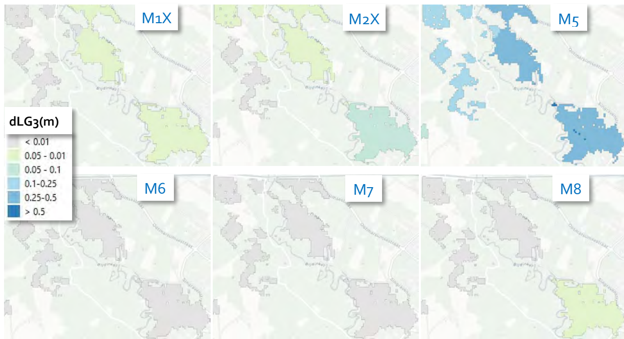
Figuur 79. Met het LHM gesimuleerde stijging van de laagste grondwaterstand (dLG 3 ) onder de grondwaterafhankelijke natuur van Landgoed Singraven door een aantal hypothetische maatregelen: M1X – Drinkwaterwinning stoppen, M2X – Beregening stoppen, M5 – Stuwpeil en drainageniveau +30 cm; M6 – Ondergrondse zoetwaterberging, M7 – Naaldbos naar heide, M8 – Afkoppelen bebouwd gebied.
