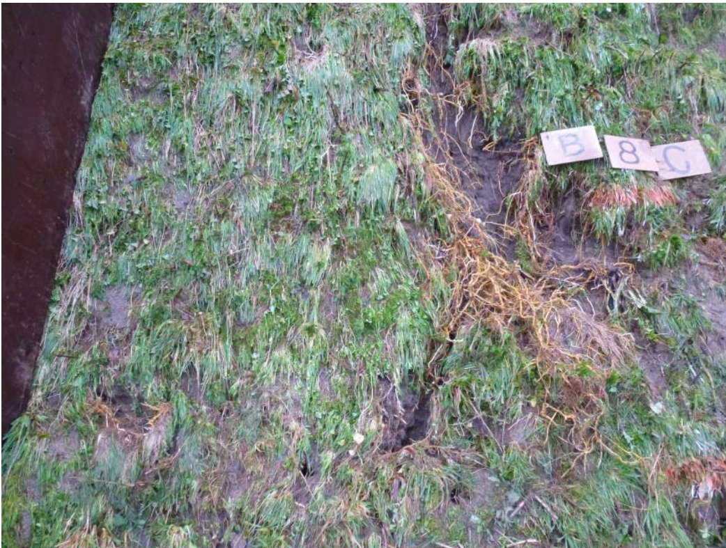
Figuur 73 Nulsituatie grasbekleding Teststrook III vak 8C, na hydraulische metingen (Infram, 2015, Factual report)
