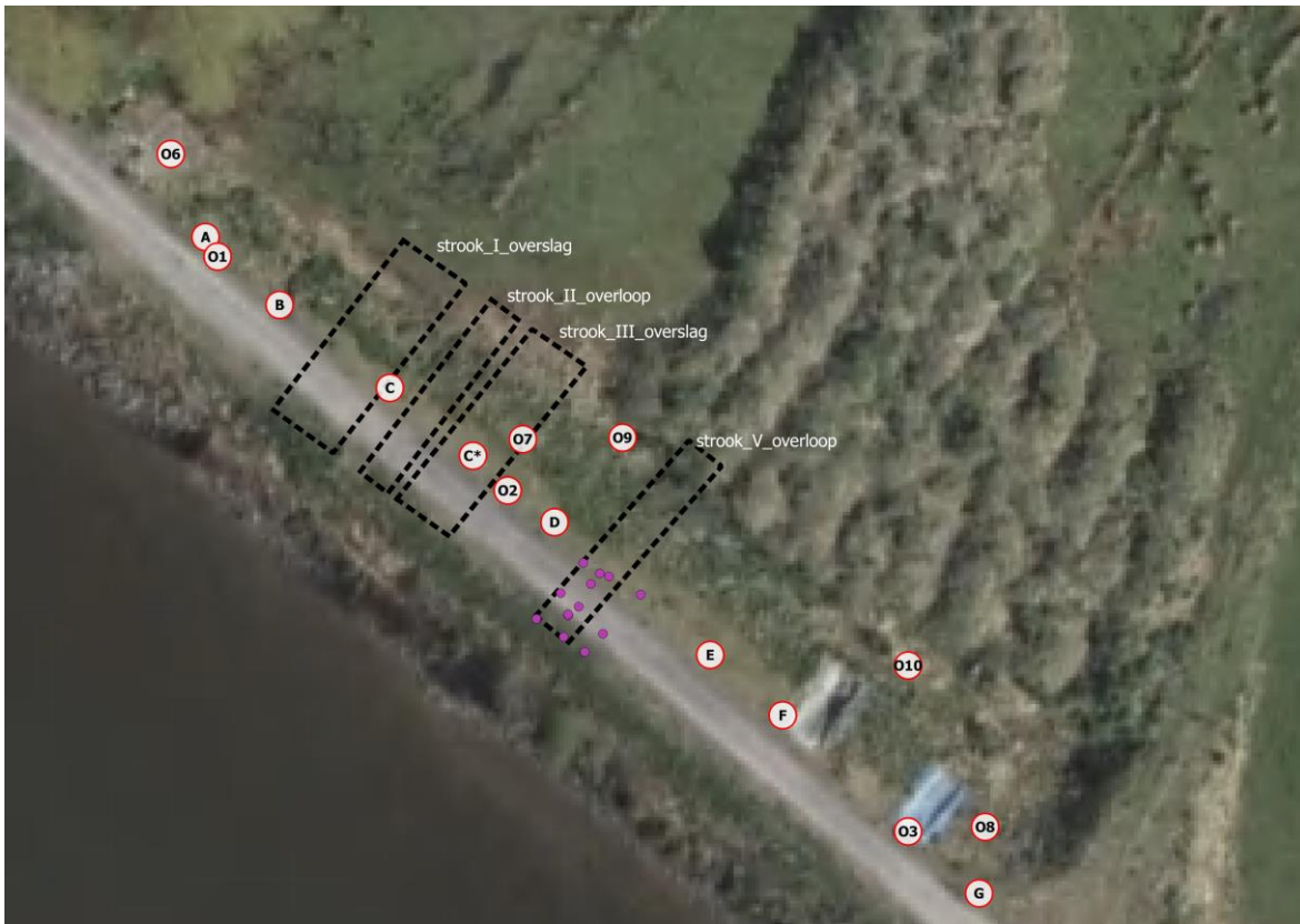
Figuur 16 Locaties G-tec boringen met indicatie van ligging proefsecties. Paarse bolletjes zijn GEO-boringen
