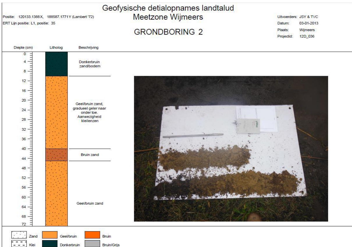
Figuur 77 Boring O2 (G-tec, 2014)
